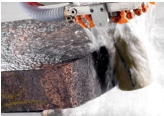
Шлифовка кромки массива.
